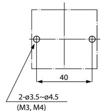
Винтовая клемма/Монтаж на рейку
